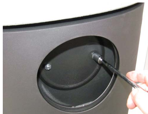
Fig. 9 : desserrage du couvercle d'obturation
