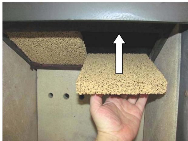
Fig. 11 : montage filtre HiClean®
