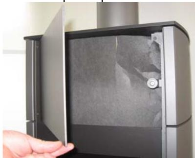
Retirez l'isolation avant de retirer les plaques de protection thermique du haut et du bas (vermiculite). Desserrez ensuite les deux vis situées au niveau du profilé en U de manière à pouvoir retirer ce dernier. Retirez maintenant le couvercle de la trappe de visite.
