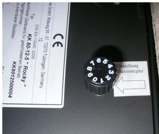
Fig. 12 : molette de réglage du thermorégulateur - vue par l'avant
