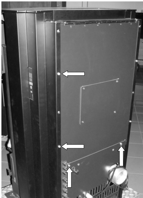
Fig. 181 : démontage de l'habillage Topline
