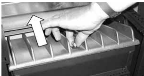
Fig. 132 : démontage du couvercle en fonte
