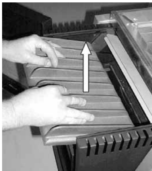
Fig. 52 : retrait du couvercle en fonte
