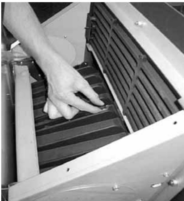
Fig. 51 : desserrage du couvercle en fonte
