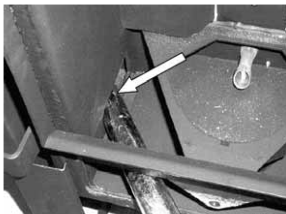
Fig. 158 : nettoyage du tirage de gaz de combustion inférieur
