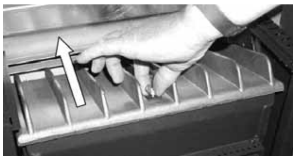
Fig. 147 : démontage du couvercle en fonte
