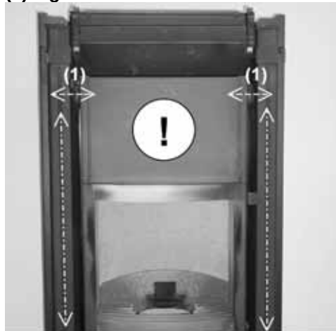
Fig. 110 : nettoyage des manchons de raccordement
