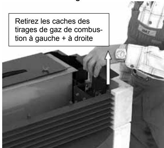
Fig. 108 : retrait du cache des tirages de gaz de combustion
