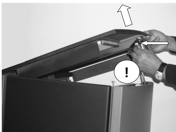
Fig. 79 : desserrage du câble du panneau de commande
