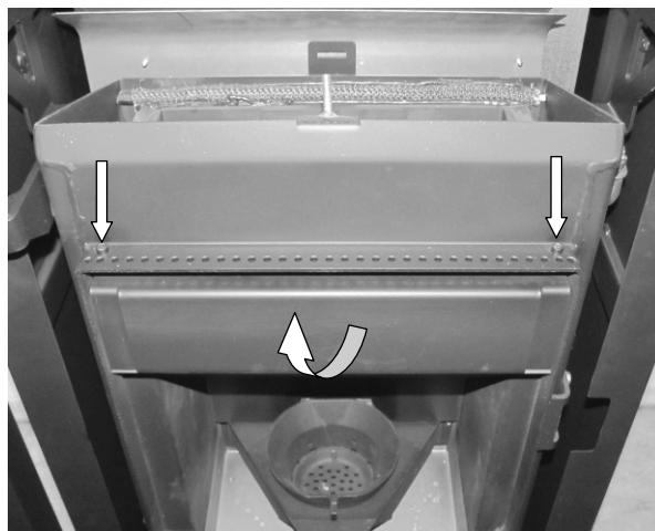
Fig. 163 : démontage de la tôle de déflexion
