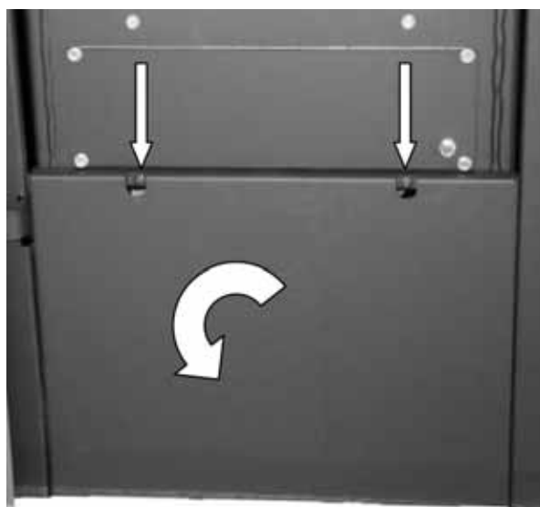
Fig. 49 : démontage du tablier d'habillage
