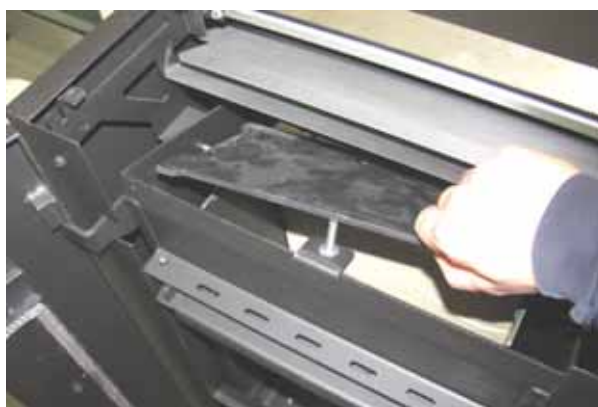
Fig. 39 : retrait du déflecteur supérieur
