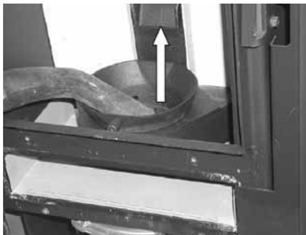
Fig. 72 : nettoyage du pot brûleur
