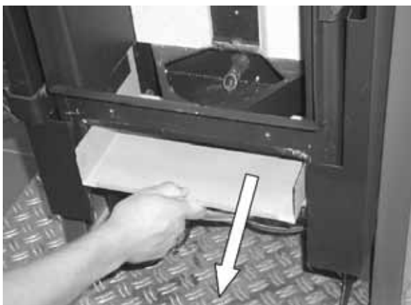
Fig. 74 : retrait de la tôle de fond
