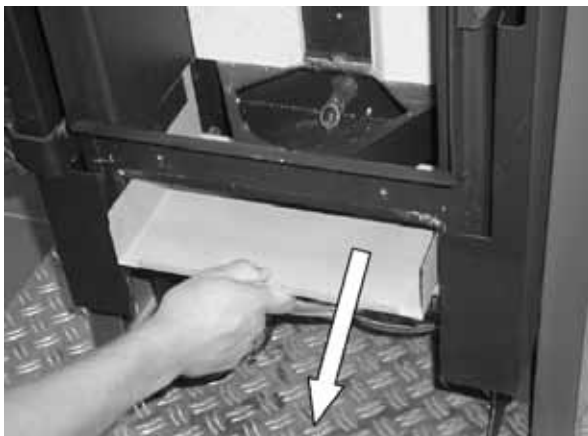
Fig. 89 : retrait de la tôle de fond
