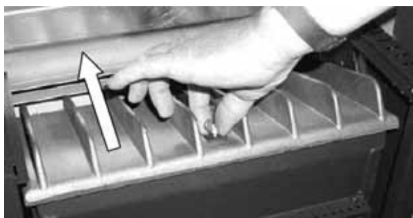
Fig. 66 : démontage du couvercle en fonte
