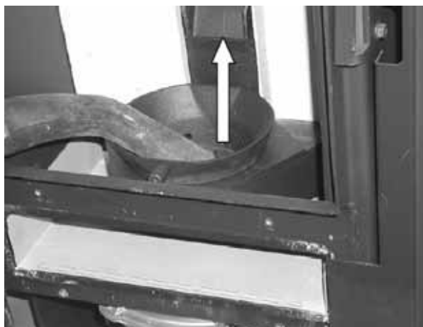
Fig. 99 : nettoyage du pot brûleur
