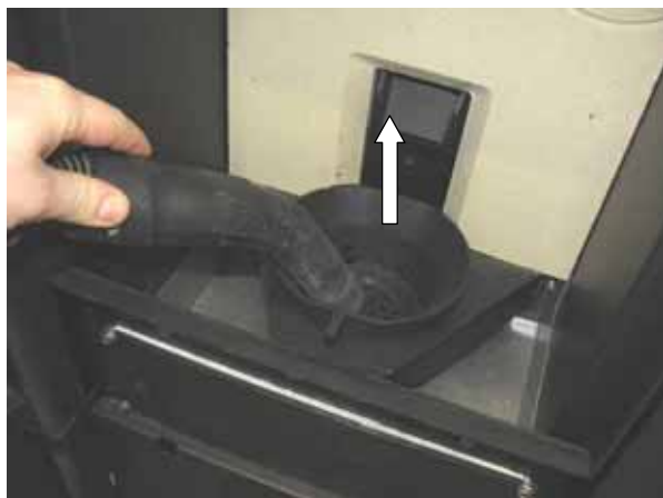
Fig. 44 : nettoyage du pot brûleur
