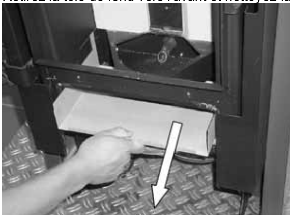
Fig. 127 : retrait de la tôle de fond
