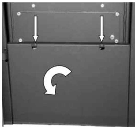
Fig. 77 : démontage du tablier d'habillage
