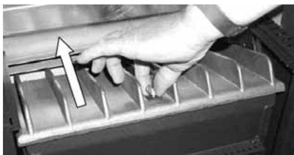
Fig. 80 : démontage du couvercle en fonte
