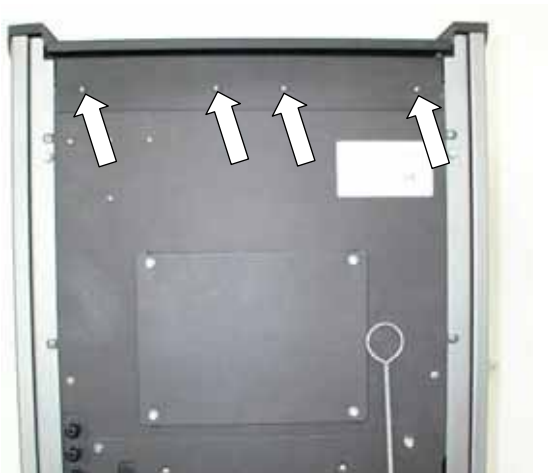
Fig. 78 : démontage du couvercle de l'habillage
