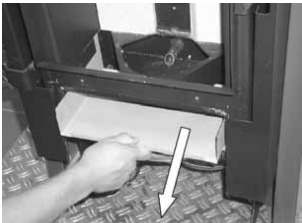
Fig. 61 : retrait de la tôle de fond
