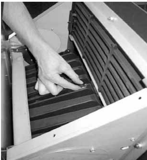
Fig. 117 : démontage du couvercle en fonte
