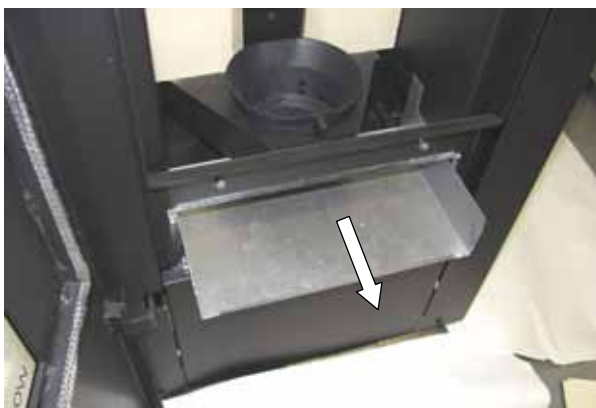
Fig. 46 : retrait de la tôle de fond
