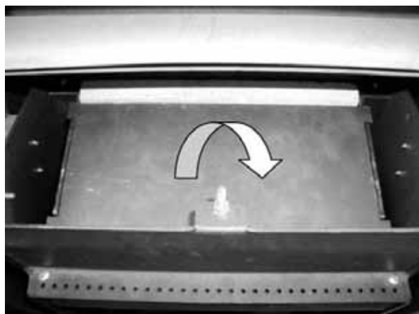
Fig. 53 : retrait du déflecteur supérieur
