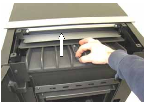
Fig. 38 : démontage du couvercle en fonte
