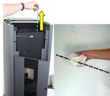
Fig. 86 : retrait et nettoyage turbulateur
