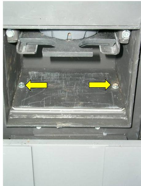
**Fig. 89 : tôle de fond soufflerie**
