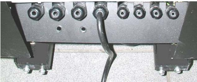
Fig. 34 : barre de raccordement centrale arrière
