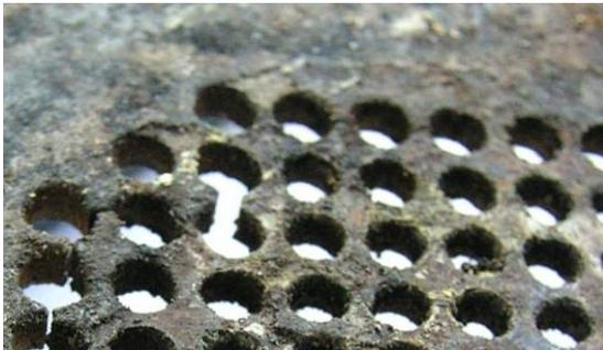
Fig. 79 : matériau de la grille fissuré
