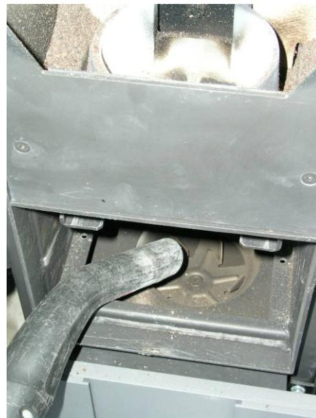
**Fig. 90 : nettoyage soufflerie**
