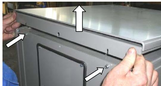
Fig. 11 : démontage du couvercle
