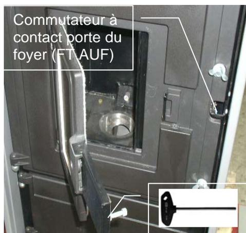
Fig. 92 : ouvrir la porte du foyer de combustion
