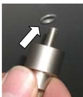
Fig. 26 : boulon de retenue rond
