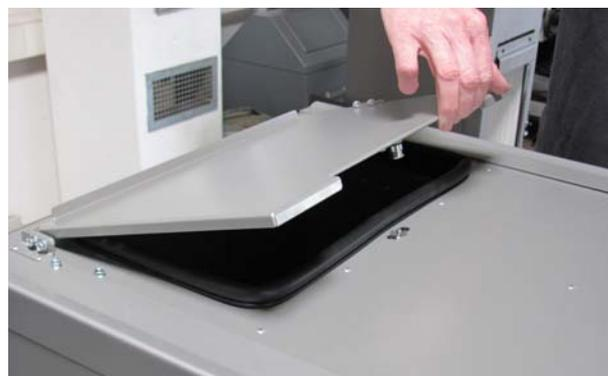
**Fig. 86 : ouverture du réservoir à pellets**
