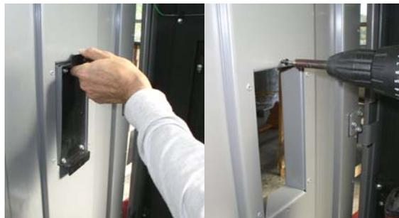
Fig. 23 : démontage / montage écran de protection
