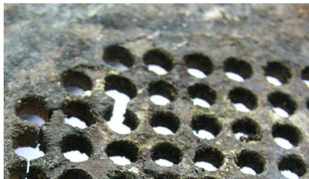
Fig. 124 : grille pivotante fissurée
