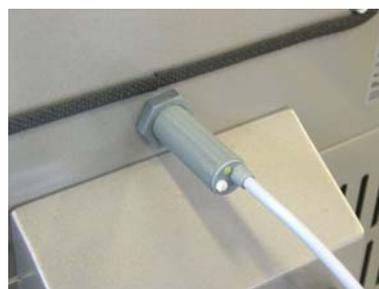
Fig. 62 : capteur de niveau installé
