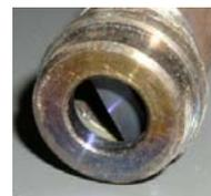
Fig. 129 : sortie d'air élément d'allumage ZP 5
