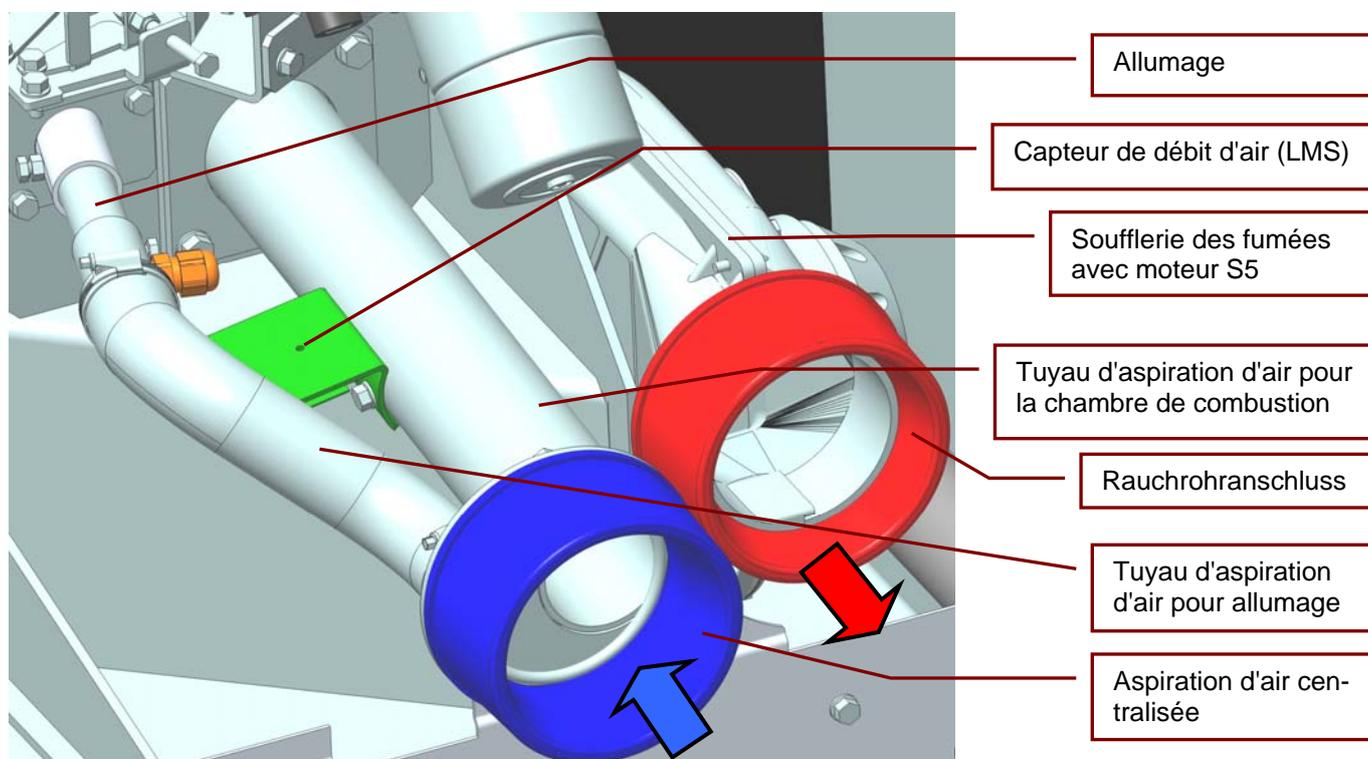
Fig. 141 : manchon d'admission d'air et d'air vicié BM 01
