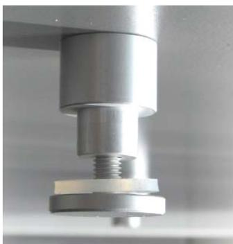
Fig. 38 : vis de serrage vissée
