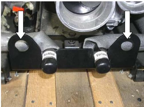
Fig. 9 : anneaux de levage arrière
