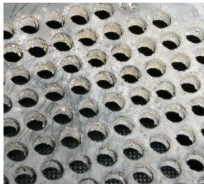
Fig. 122 : grille pivotante nettoyée correctement
