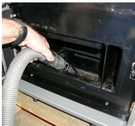
Fig. 107 : aspiration de l'accumulateur des gaz de combustion
