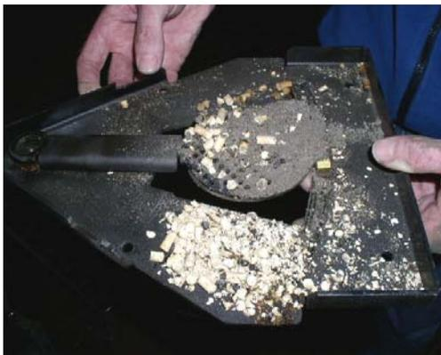
Fig. 126 : retirer la grille pivotante du support
