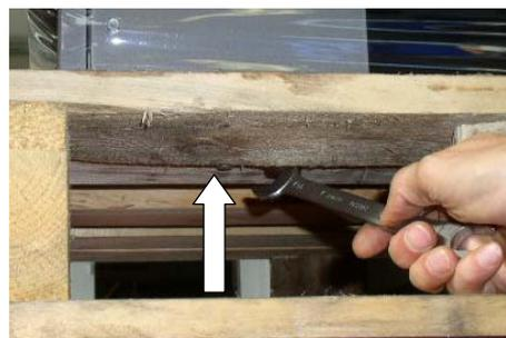
Fig. 4 : position des sécurités pour le transport
