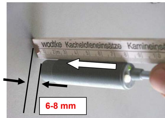
Fig. 66 : contrôle du capteur de niveau
