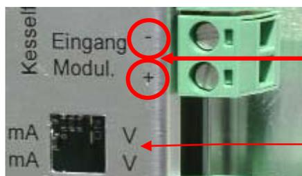
Fig. 51 : entrée Modulation
