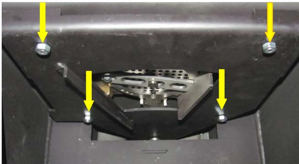
Fig. 125 : visages de la grille pivotante
