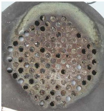
Fig. 121 : grille pivotante mal nettoyée
