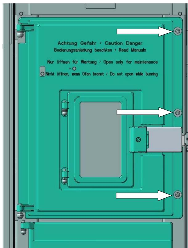
Fig. 94 : vissages portes du foyer de combustion
