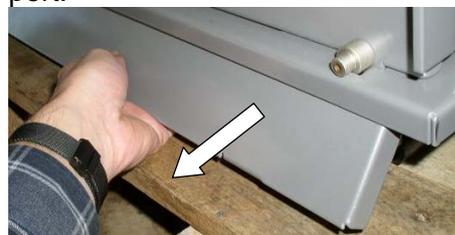
Fig. 5 : retirer les caches du socle
