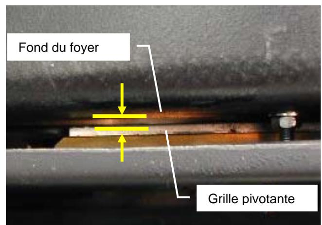
Fig. 102 : ouverture de contrôle grille pivotante
