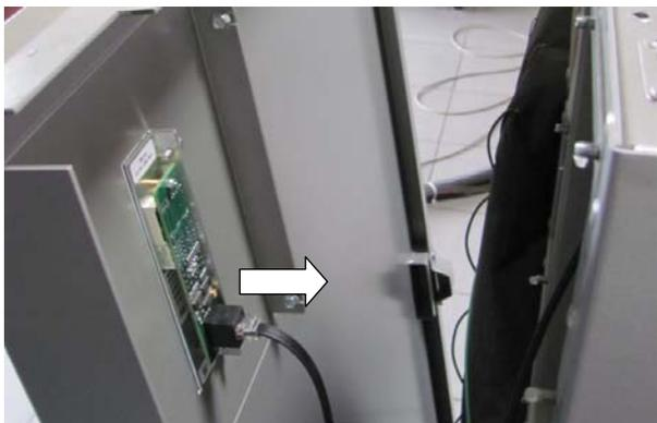
Fig. 20 : retirer le câble du panneau de commande
