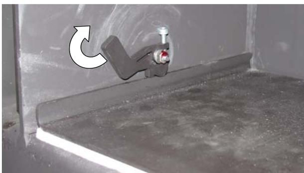
Fig. 104 : dispositif d'arrêt plaque de protection fermé
