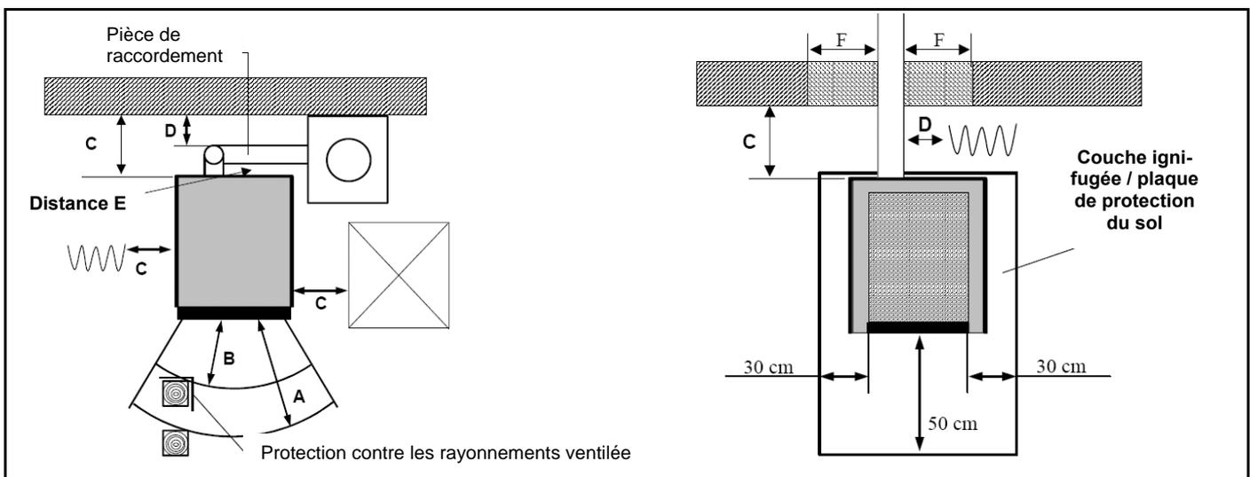
Exemple d'une pièce de raccordement à la cheminée dans la pièce où se trouve l'appareil
