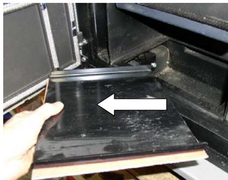
Fig. 106 : cache de l'accumulateur des gaz de combustion
