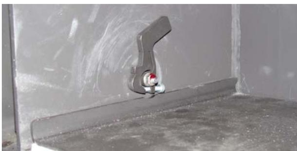
Fig. 105 : dispositif d'arrêt cache ouvert
