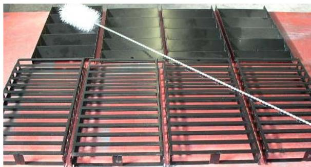
**Fig. 139 : turbulateurs et râ-teaux de l'échangeur thermique**
