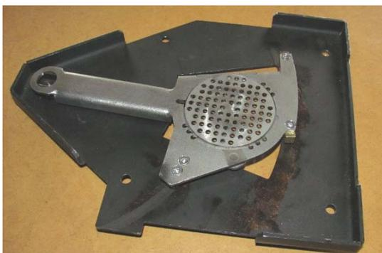
Fig. 127 : plaque de support de la grille avec grille pivotante
