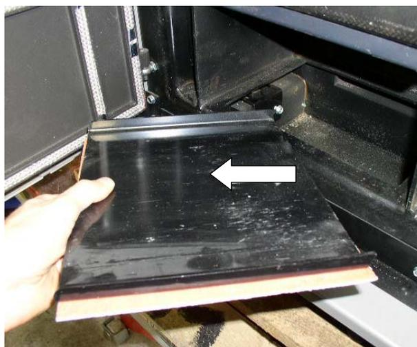
**Fig. 138 : retirer la plaque de protection de l'accumulateur des gaz de combustion**
