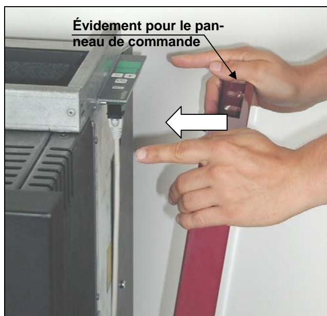
Fig. 11 : Assemblez l'habillage latéral en commençant par le bas et adossez-le à la paroi du réservoir.
